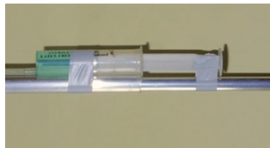
POMYSŁ: JAK ZASTOSOWAĆ STRZYKAWKĘ JAKO SIŁOWNIK DO REGULACJI I KALIBRACJI ANTEN
