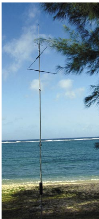
Ulubiona antena Sławka, czyli MA5V firmy Cuschkraft. Świetnie pracuje na wszystkich pasmach od 20 do 10 m
