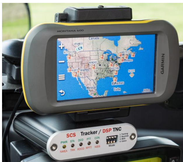
Fot. 2.6. Modem „SCS Tracker” firmy SCS wraz z odbiornikiem GPS na wyposażeniu stacji stałej
