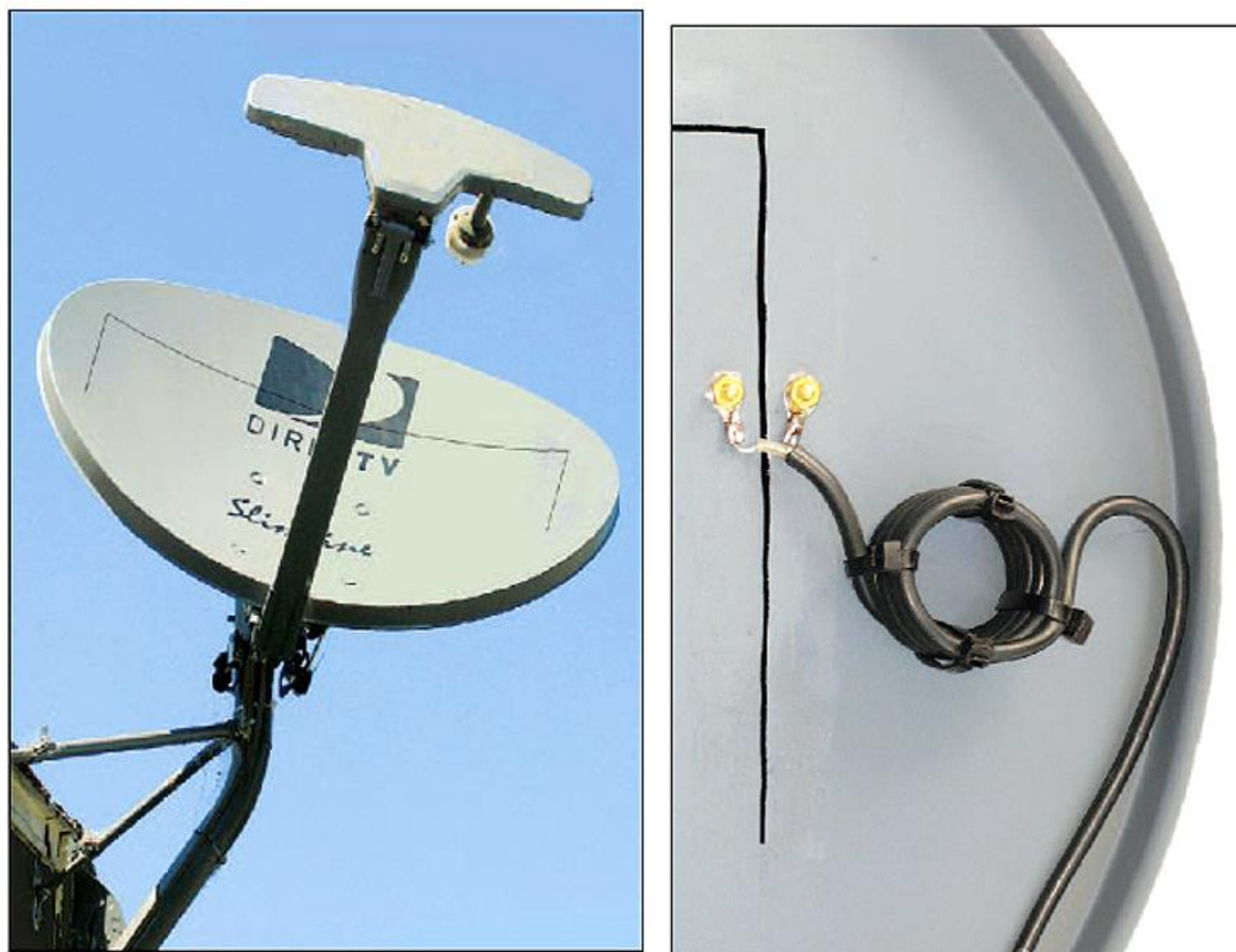
Fot. 5.1 (po lewej). Wygląd anteny. Dla zmylenia przeciwnika warto zainstalować ramię i jakąś niepotrzebną już głowicę odbiorczą. Zamiast prawdziwego ramienia metalowego można też umocować plastikową lub drewnianą atrapę, która nie wywierałaby ujemnego wpływu na promieniowaną falę Fot. 5.4 (po prawej). Sposób podłączenia kabla zasilającego
