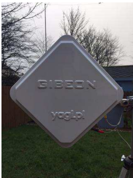
Fot. 6.5. Antena panelowa 24 dBi
