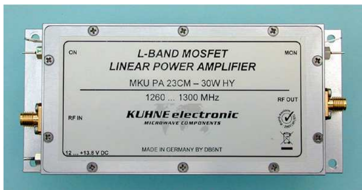
Fot. 3.4. 30-watowy wzmacniacz na zakres 1260 – 1300 MHz
