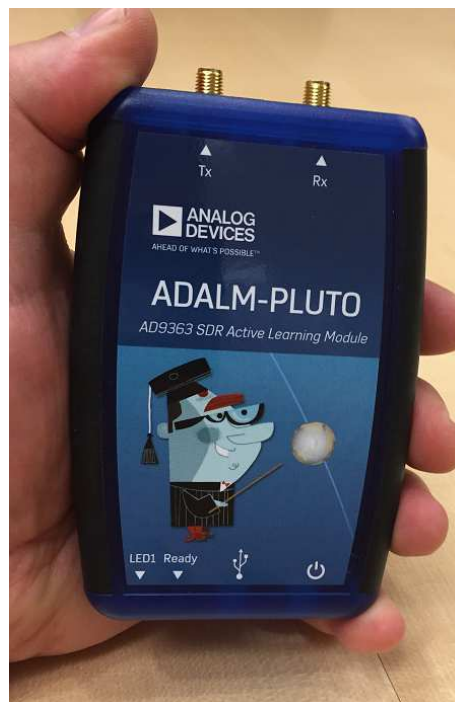
Fot. 2.13. TRX z cyfrową obróbką sygnałów „Pluto”
