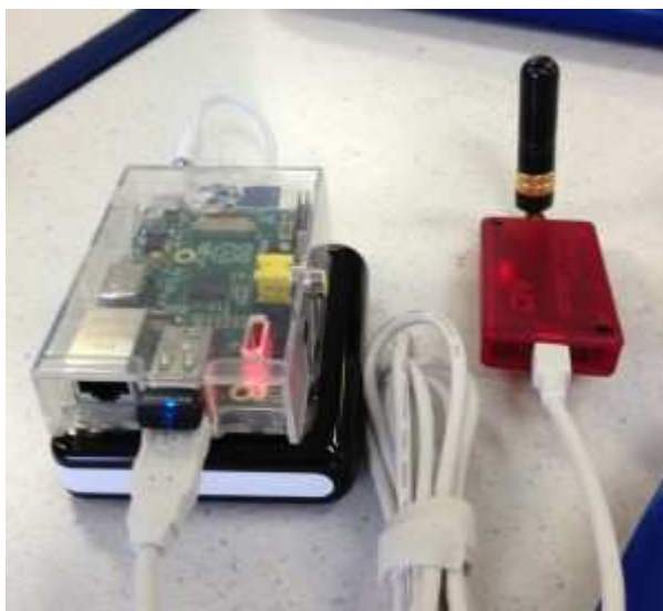
Rys. 3.1d. DVAP (po prawej stronie w czerwonej obudowie) jest innym przykładem krótkofalarskiej konstrukcji mikroprzemiennika do celów prywatnych. Może on współpracować zarówno z komputerami PC jak i z „Maliną” (tom 24). W górnym gnieździe USB powyżej szarego kabla łączącego DVAP z „Maliną” widoczne jest miniaturowy modem WiFi
