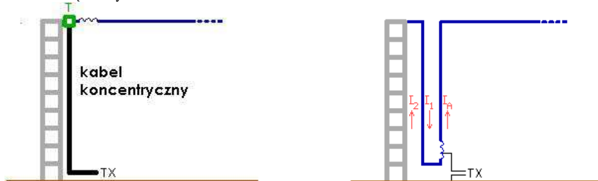
Rys. 4.12. Wykorzystanie masztu antenowego
