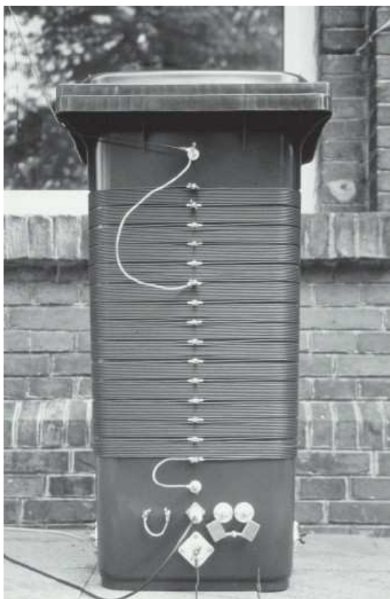
Fot. 4.27 i 4.28. Sposób wykonania cewki przedłużającej na pojemniku na odpadki
