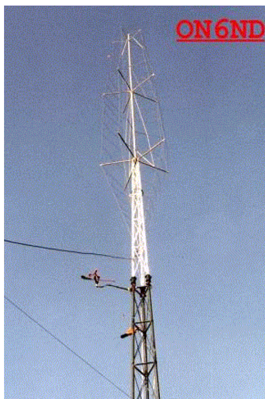
Rys. 4.5 i fot. 4.6. Antena obciążona pojemnościowo za pomocą klatki drucianej
