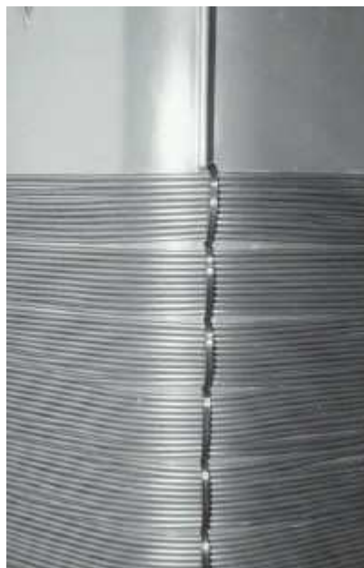
Fot. 4.27 i 4.28. Sposób wykonania cewki przedłużającej na pojemniku na odpadki
