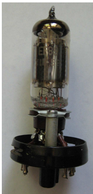
Rys. 9 Przykładowy cokół przejściowy dla lampy serii E11 i serii nowalowej
