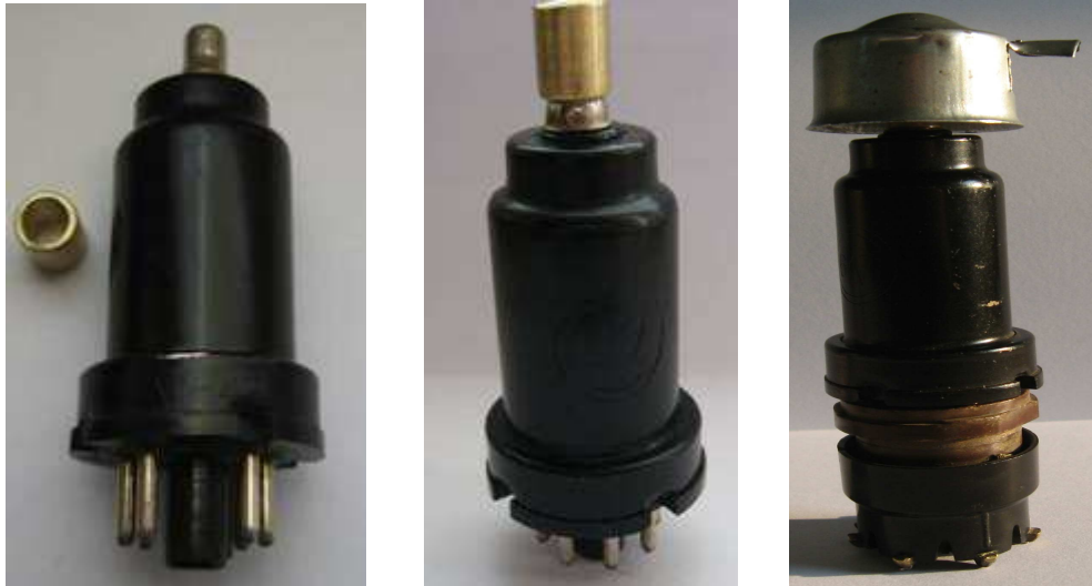
Rys. 11. Przystosowanie lampy serii oktalowej do zamiany na lampę serii bocznostykowej
