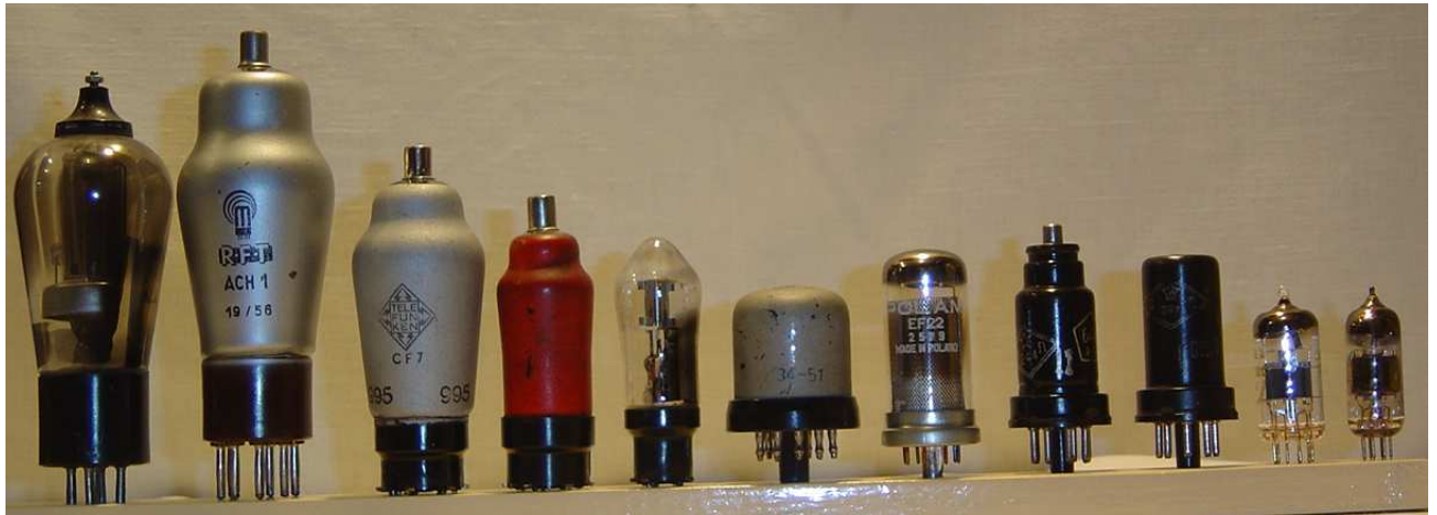
Rys. 7. Fotografie lamp radiowych od typu nóżkowego do heptalowego
