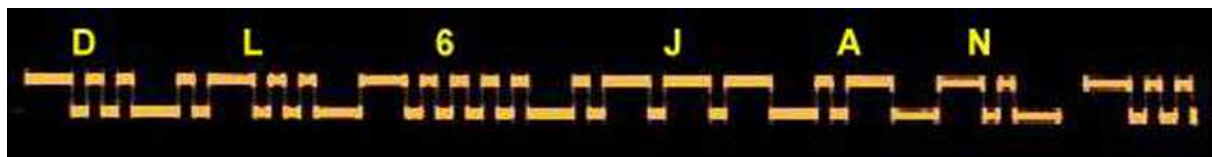
Rys. 1.2. Telegrafia FSCW. Częstotliwość wyższa odpowiada elementom znaku a niższa – przerwom
