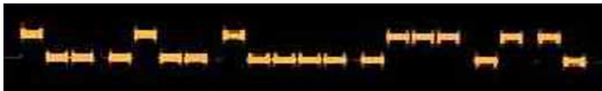
Rys. 1.3. Telegrafia DFCW. Częstotliwość wyższa odpowiada kreskom a niższa kropkom. Brak sygnału w przerwach między elementami
